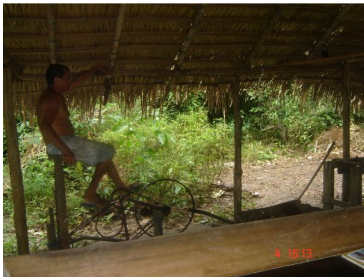
Fotografia 38 – A energia humana movendo a máquina que mói a mandioca
